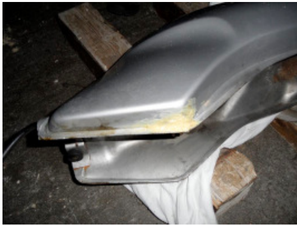
Abb.10: erfolgreiche Tankreparatur mit Megabond
