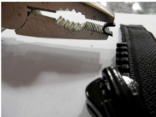
Abb.10:....und mit der Kombizange verpressen
